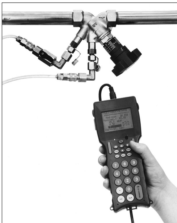
Измерительный прибор „OV-DMC 2“ арт. № 106 91 77 с „Hydrocontrol VTR“
