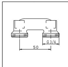
для замыкания прямой и обратной линии при более позднем монтаже радиаторов
