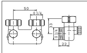
угловой, с функцией отключения, межосевое расстояние 50 мм
