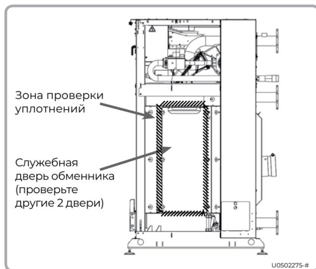
Рисунок 41 – Газонепроницаемость служебной двери
