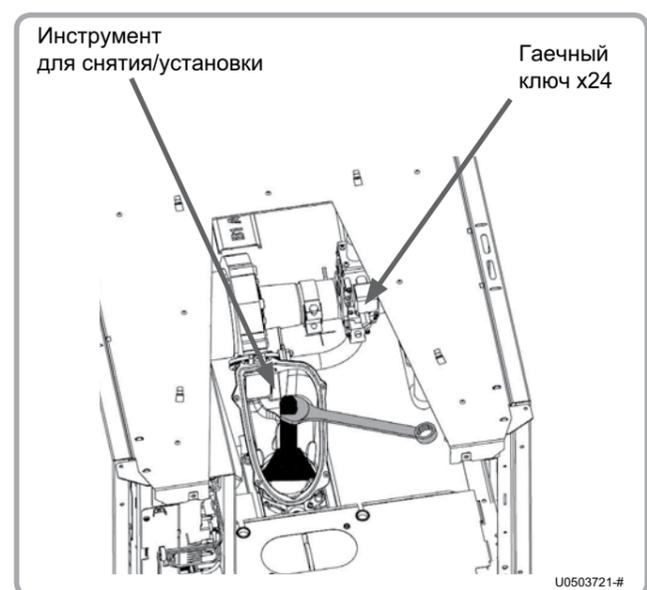
Рисунок 54 – Открытие трубки горелки
