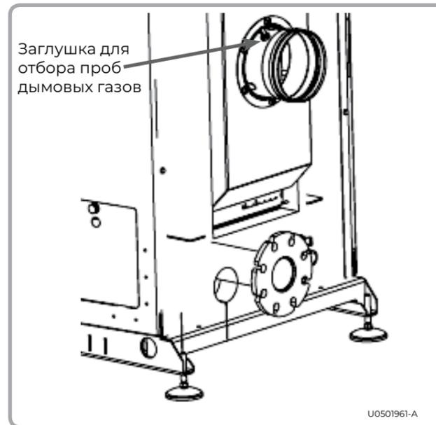
Рисунок 34 – Отбор пробы дымовых газов
