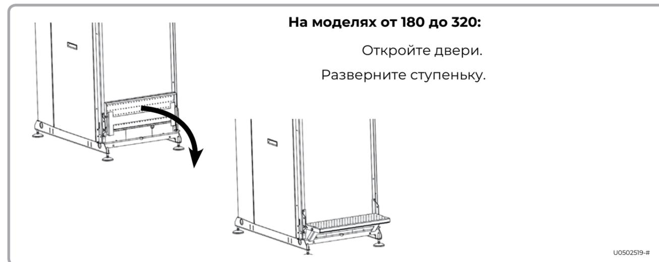
Рисунок 14 – Установка ступенек на моделях 180-320
