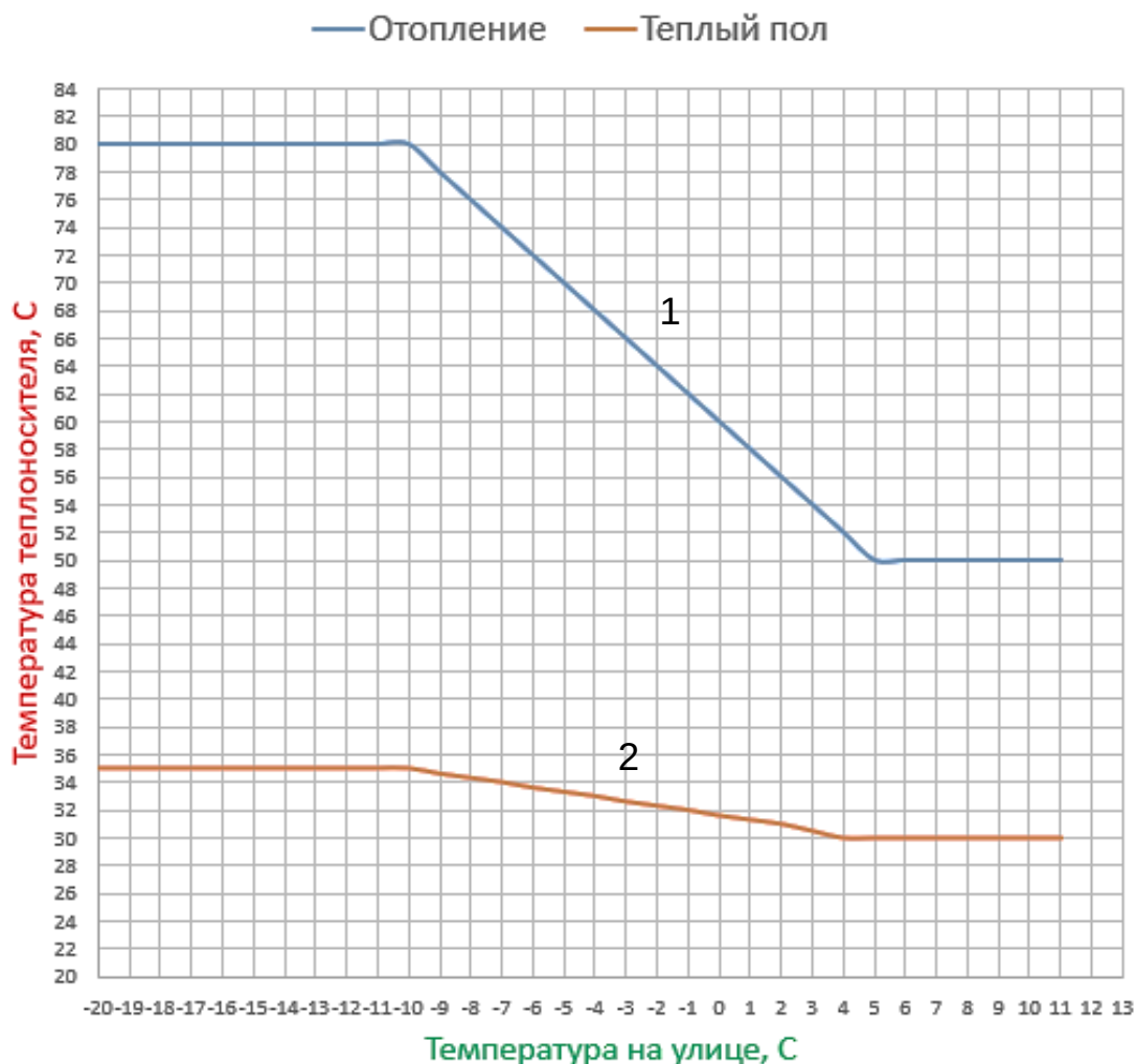
Рис 7. Графики компенсации уличной температуры.
