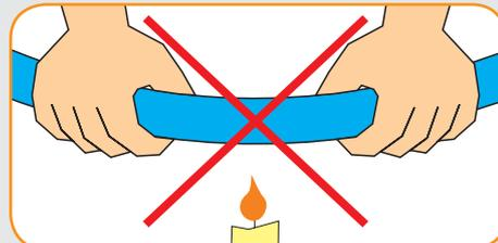
Рис. 22 – Трубы нельзя изгибать после нагрева с помощью открытого огня или горячего воздуха.
