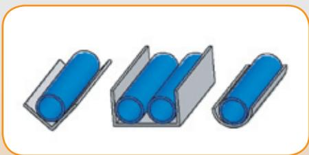
Рис. 33 – Укладка трубопровода в пустом желобе.
