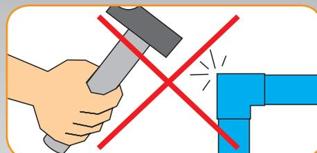
Рис. 18 – Пластиковые элементы/детали следует защищать от резких ударов и механического повреждения в течение всего времени монтажа.
