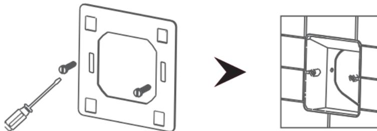
б) После подключения проводов, зафиксируйте терморегулятор на прикрученную металлическую рамку. Используйте отвертку с плоским шлицем. Терморегулятор имеет 4 точки для фиксации. Не используйте чрезмерных физических усилий при защелкивании терморегулятора к металлической рамке, не надавливайте на дисплей терморегулятора. Для более удобного монтажа, возможно отсоединить лицевую панель, зафиксированную на 6 точках крепления – 3 в верхней части и 3 в нижней.
